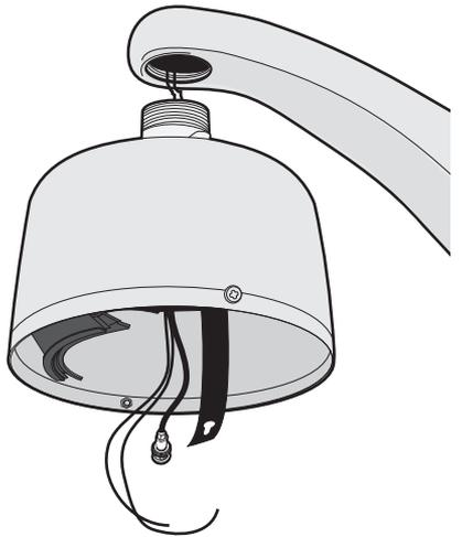
**Figura 6.** Conexión de la caja posterior colgante con el soporte
